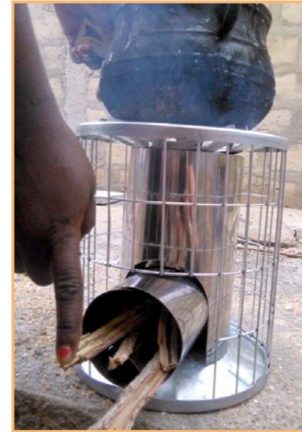
Der Pyrolyseherd im Praxistest Foto: Pia Duitsmann, BEI
